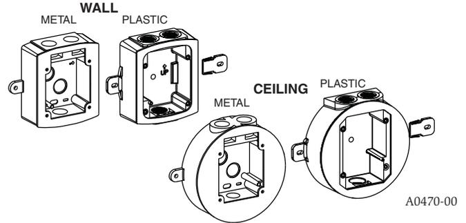
**FIGURE 2. WALL AND CEILING SPEAKER/STROBE WEATHERPROOF BACKBOX:**
